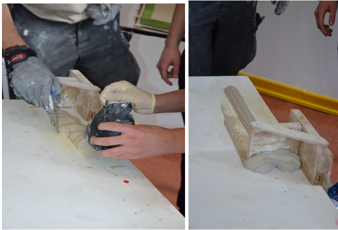
Nur ein Aspekt der vielfältigen Malerausbildung: Zwei Praktikanten des IB fertigen Stuckleisten aus Gips an.
